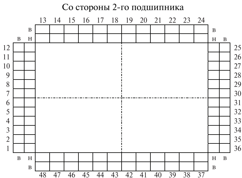
Рисунок 2 – Схематическое изображение головок лобовых частей обмотки статора со стороны 2-го подшипника (нумерация витков согласно электрической схеме обмотки статора)
